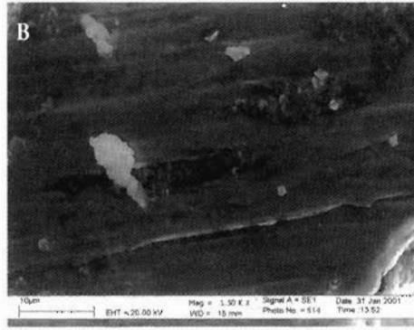
Fig. 1 a,b - Microfotografie SEM a differenti ingrandimenti delle tipiche microfessure presenti sulla superficie di strumenti endodontici nuovi e mai autoclavati. Aspetto della superficie di un ProFile a 80 ingrandimenti (a) e a 1.500 ingrandimenti (b).
